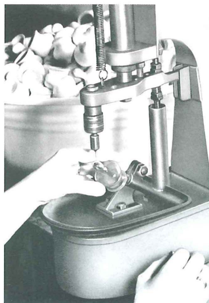
Abb. 1 Historische Saugherstellung aus den 1950er-Jahren, halbautomatische Lochung von Trinksaugern
